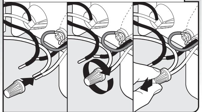
**REMARQUE :** Ne pas torsader à l'avance les fils à brins. Installer un connecteur de fils (homologation UL/CSA) (mouvement de vissage). Tirer doucement sur les conducteurs pour vérifier qu'ils sont solidement connectés.
